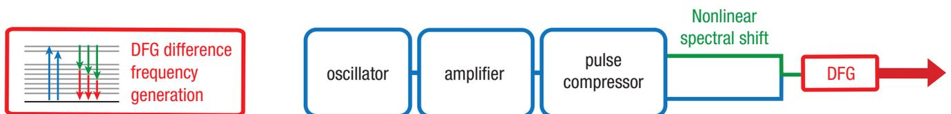
当社のターンキーで信頼性の高いfigure 9°ファイバーレーザー発振器を基に、高非線形ファイバーのスペクトルシフトを利用して、2色のフェムト秒ファイバーレーザーシステムを実現しました。波長の異なる2つのフェムト秒パルスを空間的、時間的に重ね合わせ、非線形結晶に集光し、差周波発生(DFG)により3  $\mu\text{m}$ から5  $\mu\text{m}$ までの中赤外域のフェムト秒パルスを高出力で発生させることが可能です。また、指定波長領域の波長を全自動で調整することができます。
