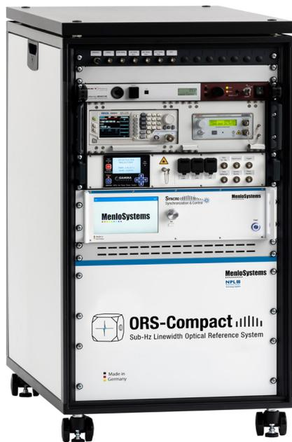
ORS-Compact超稳定激光系统专为在要求苛刻的现场应用中实现高性能而设计。它能提供超窄线宽激光光源，并具有出色的频率稳定性。
