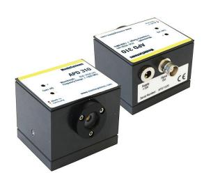
最高の感度を必要とする用途に対して、APDアバランシェフォトダイオードは従来のPINフォトダイオードに代わる極めて高い感度をご提供することができます。APDは、例えば、ナノ秒の時間スケールでパルス個体レーザーの特性評価を行うのに十分な感度と速度を有しています。また、温度補償回路により、 $10^\circ$ Cから $40^\circ$ Cの温度範囲で高い利得安定性を維持し、 $150 \lor DC$ バイアスを調整して降伏電圧付近での動作を保証致します。APD410は、紫外域から可視域にかけての感度が向上しています。
