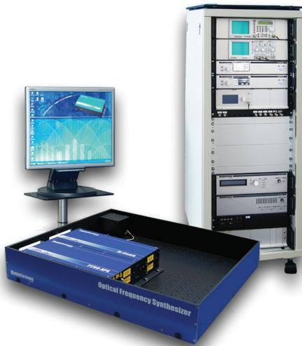
光学频率合成器FC1500是一款紧凑而灵活的、基于光纤的光学频率梳系统，可直接用于绝对地测量光学频率。Menlo独有的figure9<sup>®</sup>锁模技术，保证了激光器优良的稳定性和在超低相位噪声下运行。仅需一键开启的飞秒激光器和全自动的锁相环系统允许用户可以轻松地将此系统锁定在射频或者光学参考频率源上。得益于包含多个伺服电机的成熟化系统设计，光梳可在长达几周内连续稳定运行并保持相位锁定。为了覆盖整个可见到近红外波段（从500 nm到2100 nm）系统提供了M-VIS和M-NIR扩展包。
